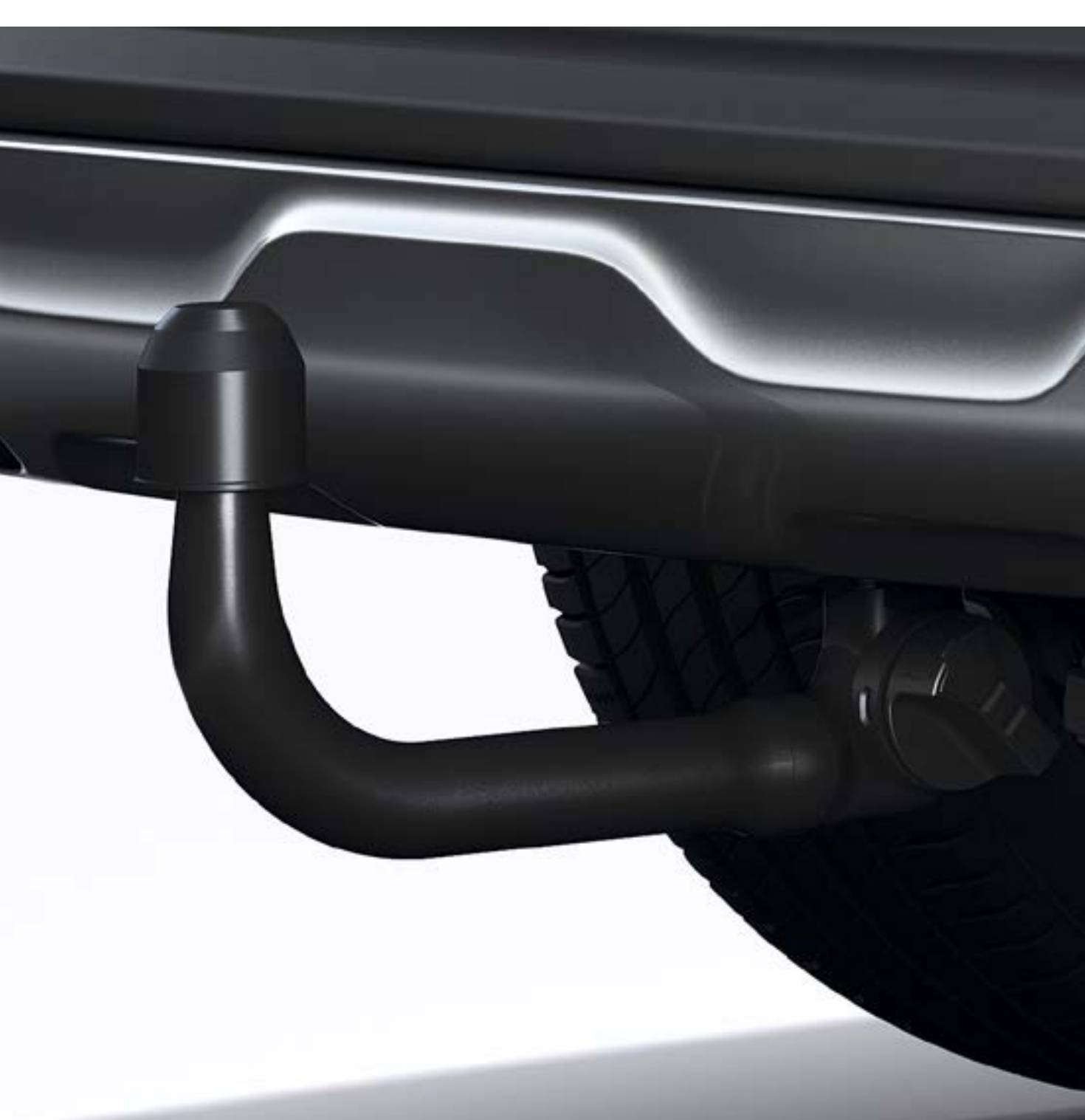
sats med dragkrok som kan demonteras utan verktyg
