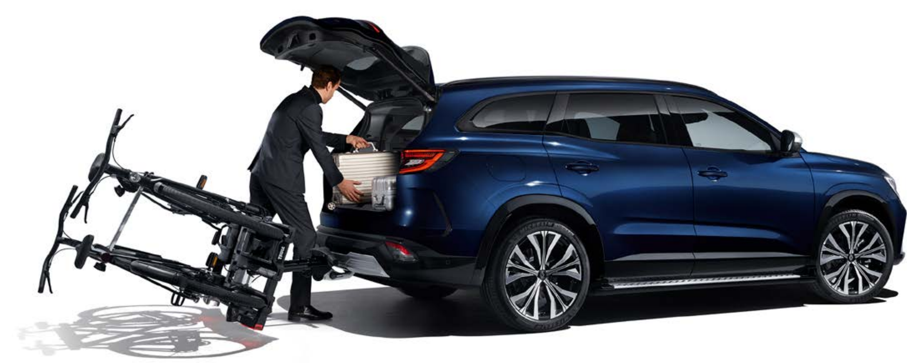
cykelhållare för tre cyklar till dragkrok – 13-polig
